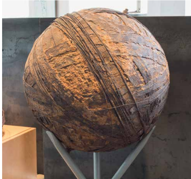
Restaurierte Drahtwicklung an einer Fieseler 103 Luftdruckkugel im Historisch-Technischen Museum Peenemünde (Foto: Historisch-Technisches Museum Peenemünde)
